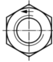
Bild 6 — Kennzeichnung für Linksgewinde
